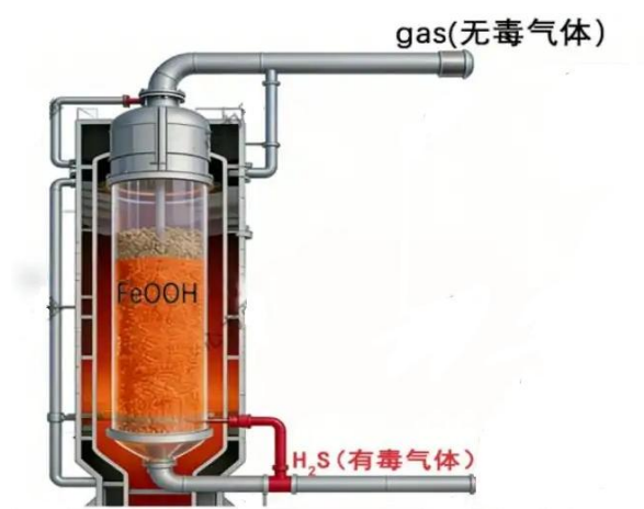
图 8.2-1 氧化铁吸附柱结构图
