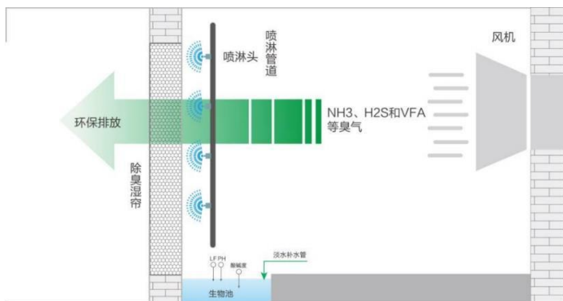
图 8.2-1 除臭湿帘喷淋净化系统工艺图
