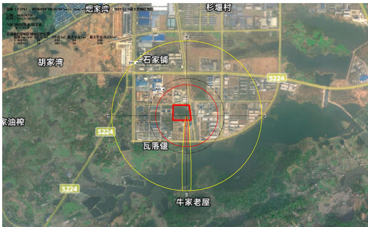
图 7.6-5b 盐酸浓度达到不同毒性终点浓度的最大影响范围示意图（最不利气象条件）
