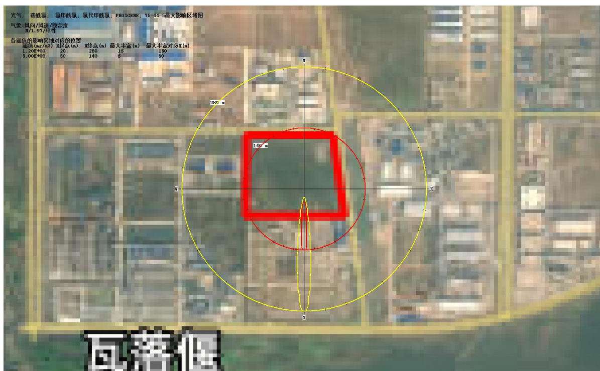
图 7.6-14b 光气浓度达到不同毒性终点浓度的最大影响范围示意图（最不利气象条件）
