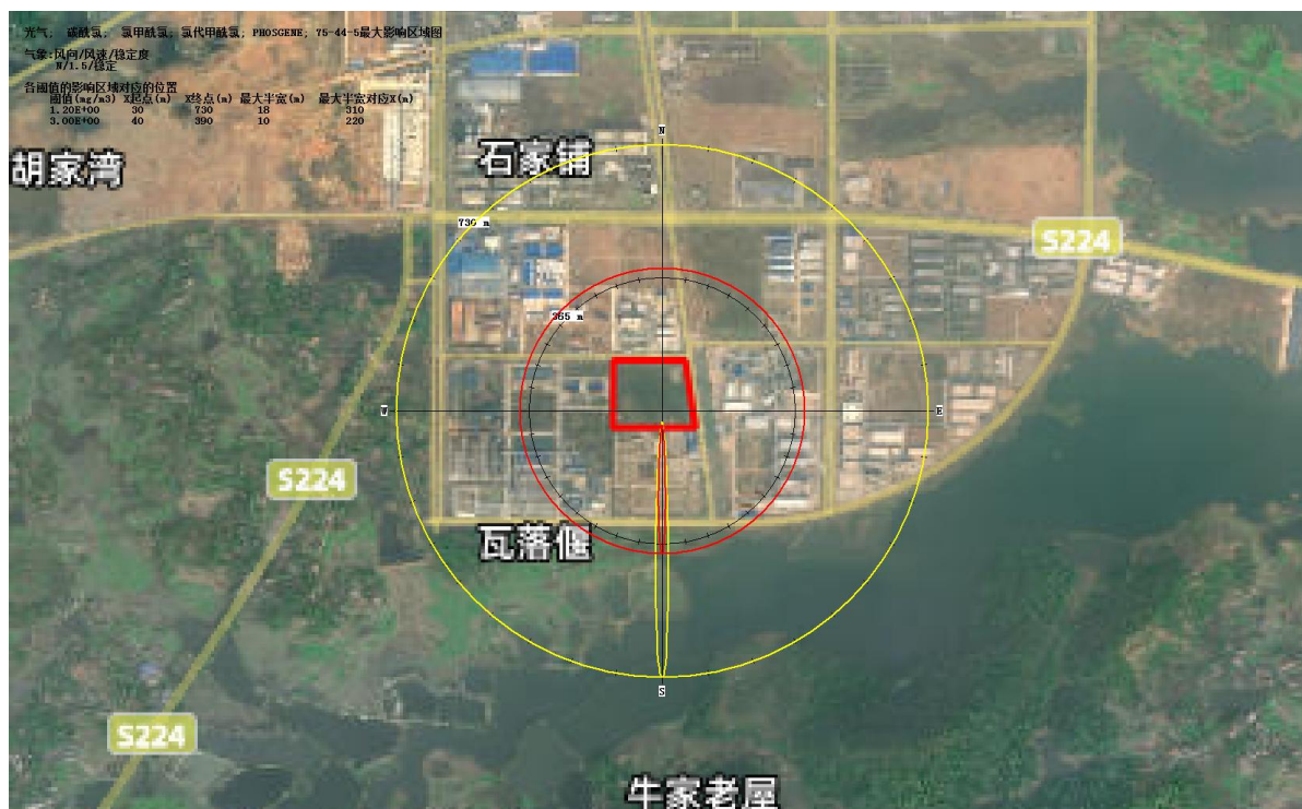
图 7.6-14a 光气浓度达到不同毒性终点浓度的最大影响范围示意图（最不利气象条件）
