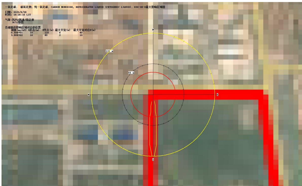
图 7.6-12b CO 浓度达到不同毒性终点浓度的最大影响范围示意图（最不利气象条件）
