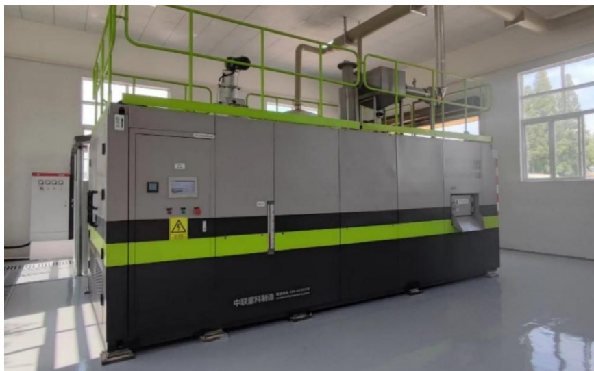
图 2-9 厨余垃圾反应器示意图
